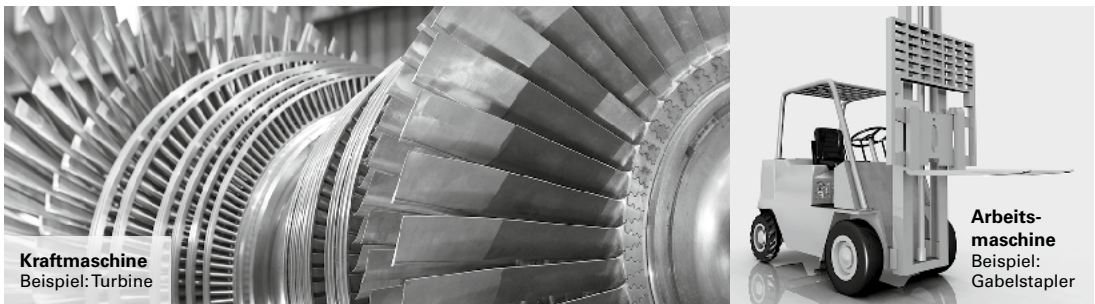
Bild 1: Beispiele für Kraft- und Arbeitsmaschinen
