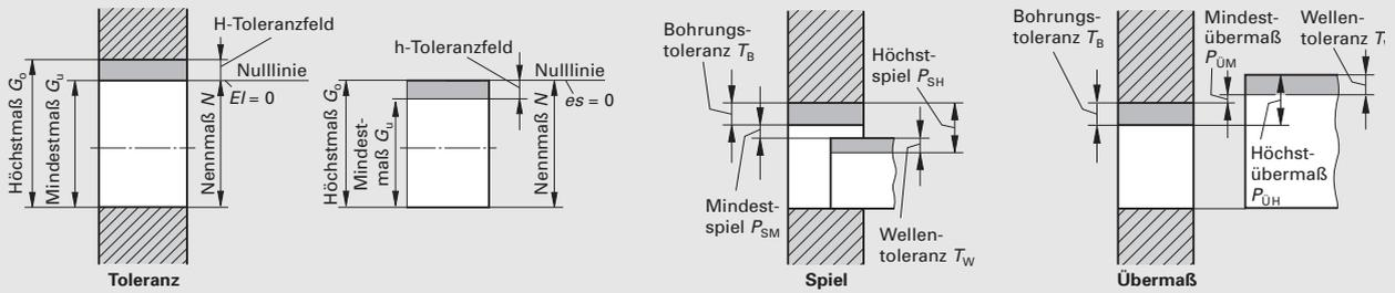
14. Berechnen Sie für das Passmaß  $\varnothing 35$  H7/f7 die Maßtoleranz sowie Höchst- und Mindestmaß von Welle und Bohrung. Liegt bei dieser Passung Spiel oder Übermaß vor?
