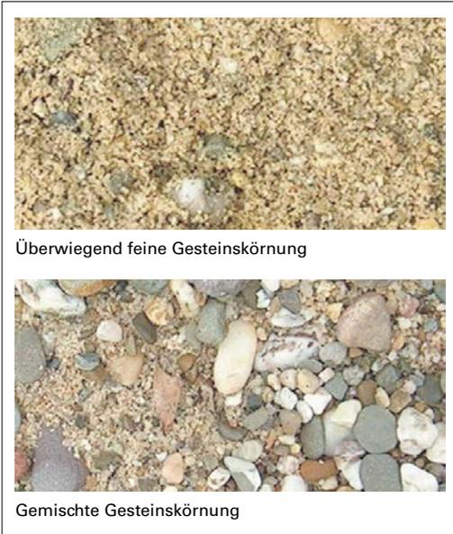
Abb. 4.37: Gesteinskörnungen mit unterschiedlichem Gefüge
