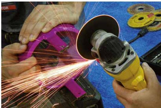
**Bild 2: Funkenspur bei einer Schleifscheibe**
