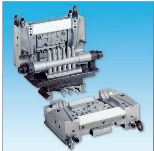
Bild 4: Diese Kokille aus Stahl ist eine Dauerform für Abgüsse von Einspritzpumpengehäusen.
