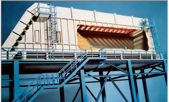
Bild 1: Maschinenmodell eines Spänebunkers im Maßstab 1:25. Werkstoffe: Acrylglas, Polystyrol, Metall
