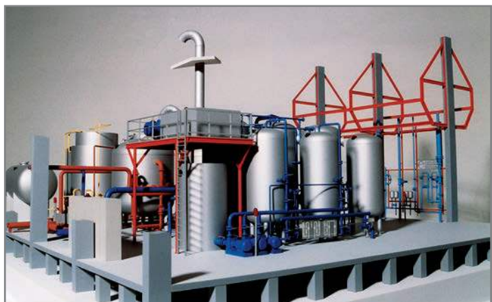
Bild 3: Anlagenmodell einer Wasseraufbereitungsanlage im Maßstab 1:25. Werkstoffe: PVC, Polystyrol, Kunststoffblockmaterial
