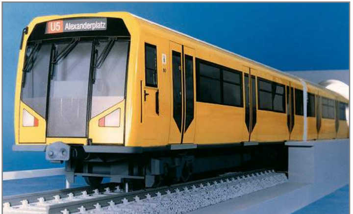
Bild 2: Fahrzeugmodell und gleichzeitig Designmodell einer U-Bahn im Maßstab 1:10. Werkstoffe: Acrylglas, PVC, Metall, Kunststoffblockmaterial
