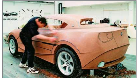
Bild 2: Designmodell im Maßstab 1:1 aus Ton modelliert (Claymodell)
