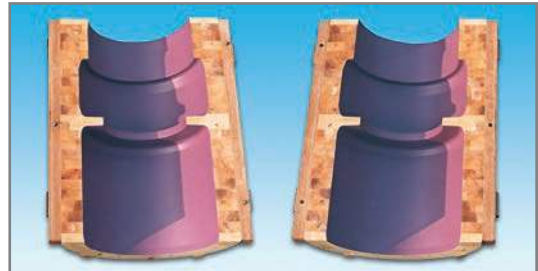
Bild 2: Der Kernkasten und das Modell von Bild 1 bilden miteinander die Modelleinrichtung aus Holz.
