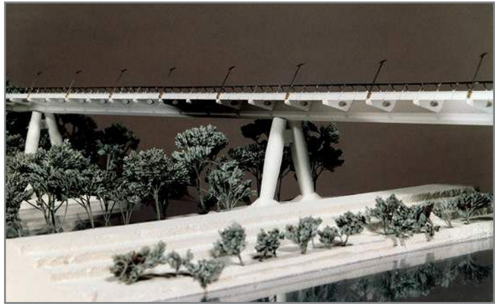
Bild 1: Baumodell einer Brücke im Maßstab 1:100. Werkstoffe: Acrylglas, PVC, Kunststoffblockmaterial
