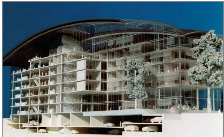
Bild 2: Architekturmodell eines Verwaltungsgebäudes im Maßstab 1:200. Werkstoffe: Polystyrol, Acrylglas
