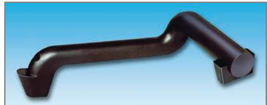
Bild 3: Die Kernseele weist die Form des Sandkerns auf. Sie wird zur Herstellung eines Kunstharzkernkastens benötigt.
