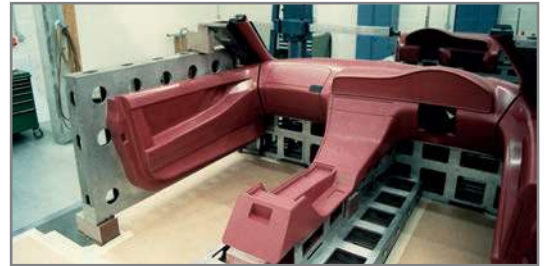
Bild 3: NEUZEIT Der moderne Modellbau ist gekennzeichnet durch Vielseitigkeit in den Anwendungsgebieten (siehe Bild 4), Werkstoffen und Technologien. Das Bild zeigt ein Beispiel aus dem Karosseriemodellbau.
