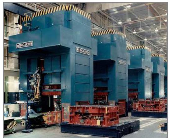
Bild 3: Umformen: Pressen von Karosserieteilen
