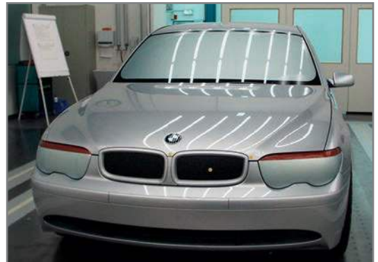
Bild 3: Datenkontrollmodell mit Spiegellinien zur Beurteilung des Formverlaufs. Aufbau: Kunststoff lackiert
