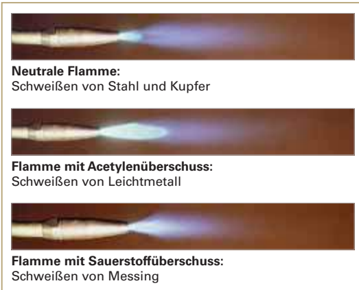
Bild 3: Acetylen-Sauerstoff-Flammen
