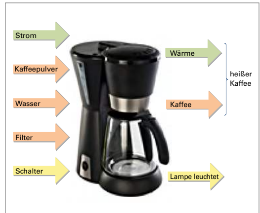
Bild 1: Kaffeemaschine als Beispiel für ein technisches System
