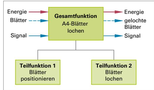
Bild 1: Gesamt- und Teilfunktionen am Beispiel eines Bürolochers
