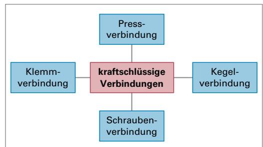
Bild 2: Kraftschlüssige Verbindungen
