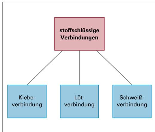
Bild 2: Stoffschlüssige Verbindungen
