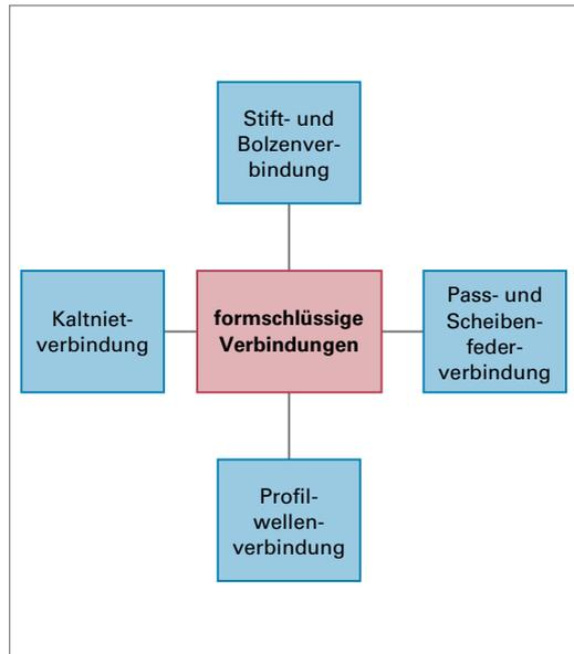
Bild 1: Formschlüssige Verbindungen
