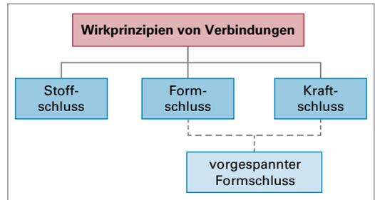
Bild 1: Wirkprinzipien von Verbindungen
