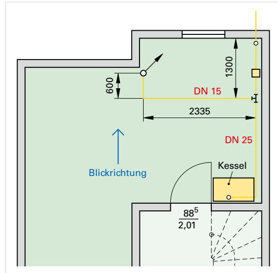
Bild 1: Gasleitung im UG, Maßstab 1: 100
