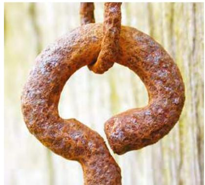
3 Korrodiertes Anschlagmittel
