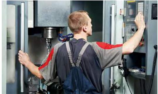
1 Schutztür an einer Fräsmaschine
