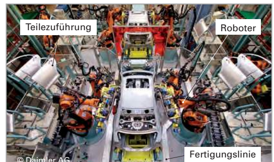
Bild 2: Roboter-Karosseriemontage mit Taktbindung
