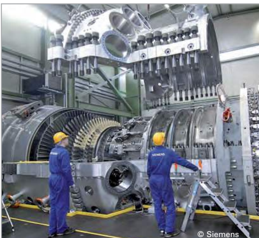
Bild 3: Montage einer Kraftwerksturbine beim Kunden
