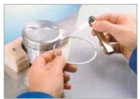
Nutenspielprüfung in den Kolbenringnuten mit Fühlerlehre.
