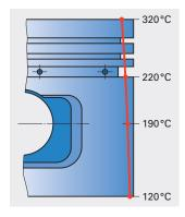
Warum klemmt der Kolben nicht im Zylinder (Ø 90,04 mm)?
