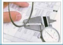
Überprüfen der Maße der neuen Kolbenringe mit Messschieber.
