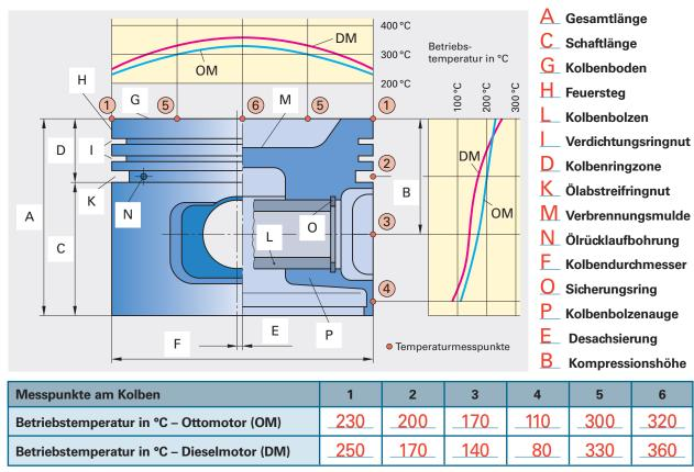
8. Auf dem zu ersetzenden Kolben befinden sich die nebenstehenden Markierungen. Erklären Sie die Angaben und geben Sie an, wo ggf. gemessen werden muss. Auf welches Zylindermaß muss gehont werden?
