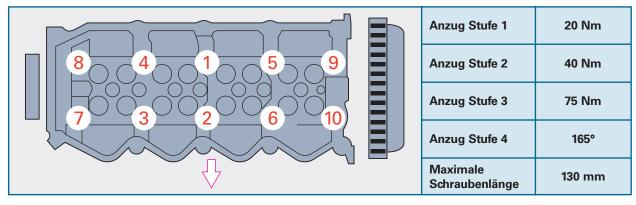
13. Warum erfolgt der Anzug der Zyinderkopfschrauben nicht in einer Stufe?
