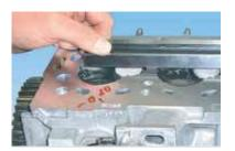
10. Welches Verdichtungsverhältnis ergibt sich nach dem Planen um 0,5 mm, wenn der Gesamthubraum des 4-Zylindermotors 1997 cm³, die Bohrung 85 mm und das ursprüngliche Verdichtungsverhältnis 11,0 beträgt.
