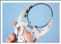
Kolbenringe mit Kolbenringzange in die Kolben einsetzen.
