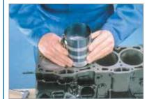
Einsetzen der gut geölten Kolben mit Montagemanschette.
