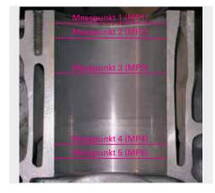
3. Es gibt Kolben für folgende Zylinderfertigmaße: Reparaturstufe 1: 84,25 mm; Reparaturstufe 2: 84,50 mm. Die erforderliche Materialzugabe für das Vorhonen beträgt 0,06 mm, für das Fertighonen 0,02 mm. Für welche Reparaturstufe müssen die Übermaßkolben beschafft werden? Begründen Sie Ihre Aussage.
