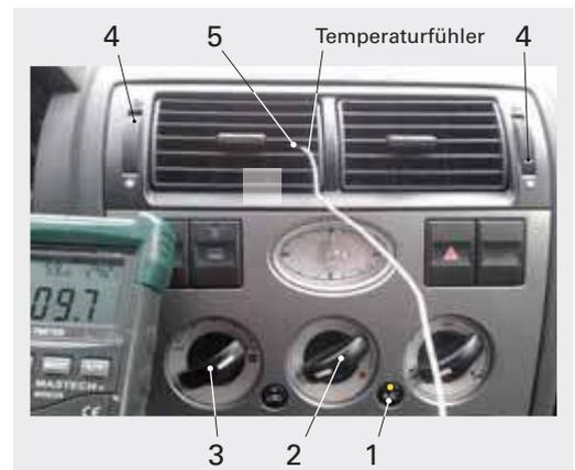
Ihr Geselle verfügt über den Sachkundenachweis (EG 307/2008) und führt vor der Kältemittelaufbereitung eine Druckprüfung mit einem für das Kältemittel zugelassenen Klima-Service-Gerät durch.
