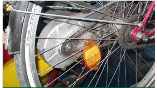
Bild 2: E-Motor am Ausfallende
