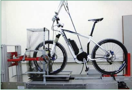
Bild 1: Bremsenprüfstand (velotech.de, Schweinfurt)
