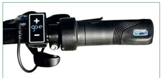
Bild 3: Motorsteuerung durch Drehgriff (ONwheel power grip)
