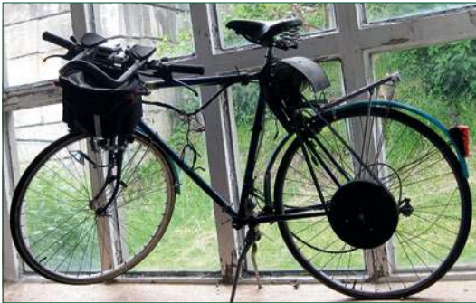
Bild 1: Riemenantrieb auf das Hinterrad. Der Akku verbirgt sich in der Lenkertasche.
