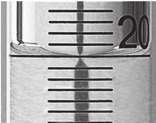
Abb. 2.4: Volumeneinstellung bei der Füllung und Volumenablesung, hier mit Schellbachstreifen
