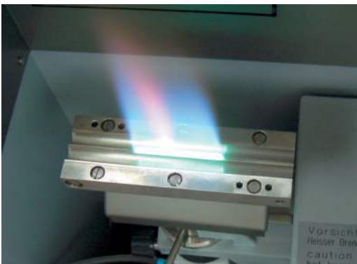
Abb. 1-11 b Schlitzbrenner mit Flamme
