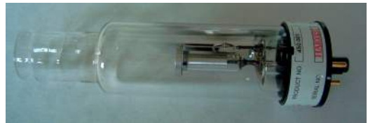
Abb. 1-6 Verschiedene Bauformen von Hohlkatodenlampen
