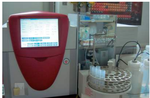
Abb. 1-3 Gesamtansicht eines AAS-Gerätes mit Probengeber und Sampler
