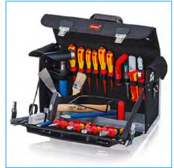
Bild 3: Werkzeugtasche eines Elektrikers, Fachrichtung Energie- und Gebäudetechnik
