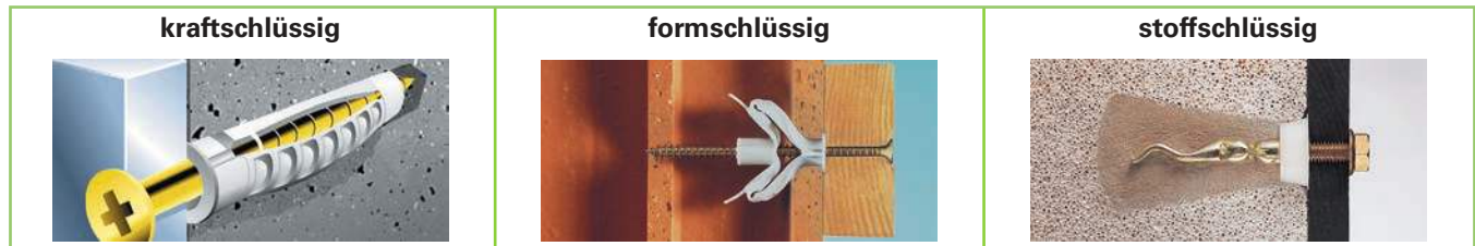
Bild 1: Dübelssysteme nach Verankerungsart
