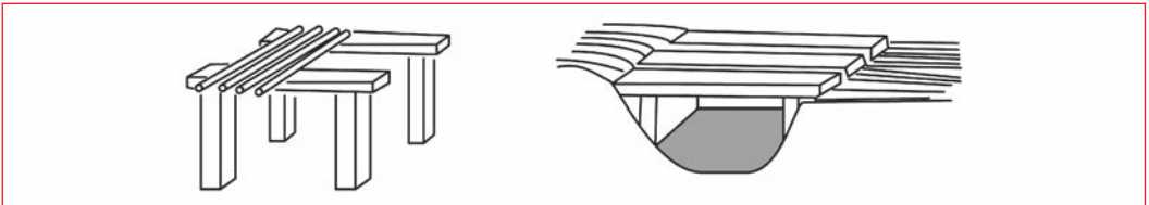
Bild 1.1 Überdecken von Öffnungen: Balken auf zwei Stützen
