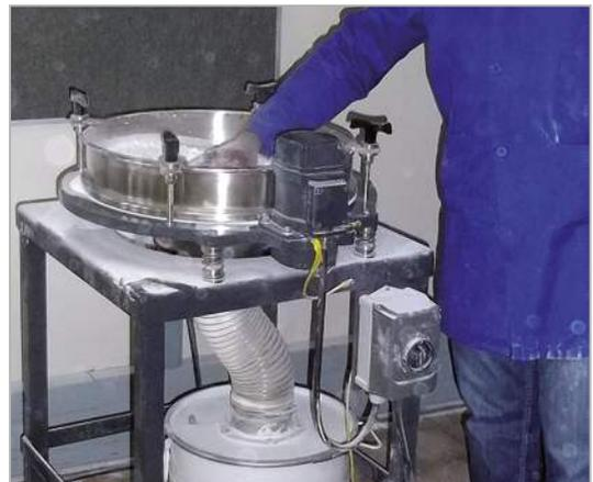
**Bild 3: Kunststoffpulveraufbereitung in Siebstation**
