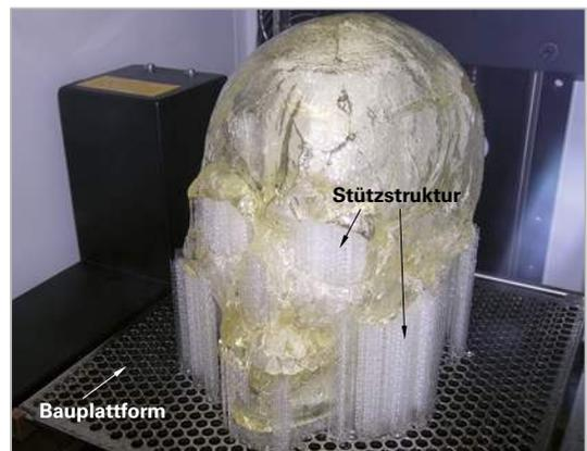
**Bild 3: Feste Verbindungen mit der Bauteilplattform**
