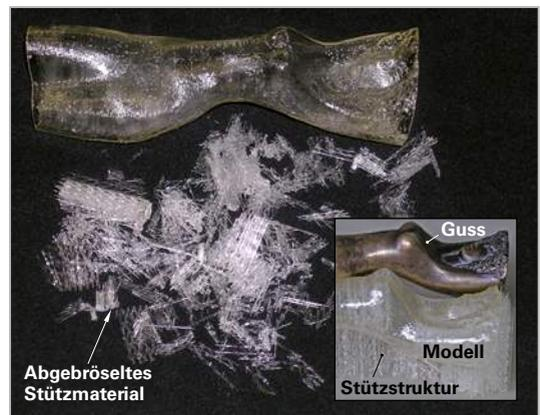
**Bild 2: Entfernen der Stützstruktur**
