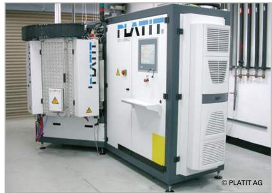
**Bild 2: PVD-Beschichten mit Sputter-Anlage**
