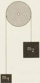
Bild 1.1.1 Rad mit festem Drehpunkt, Faden und Gewichten
